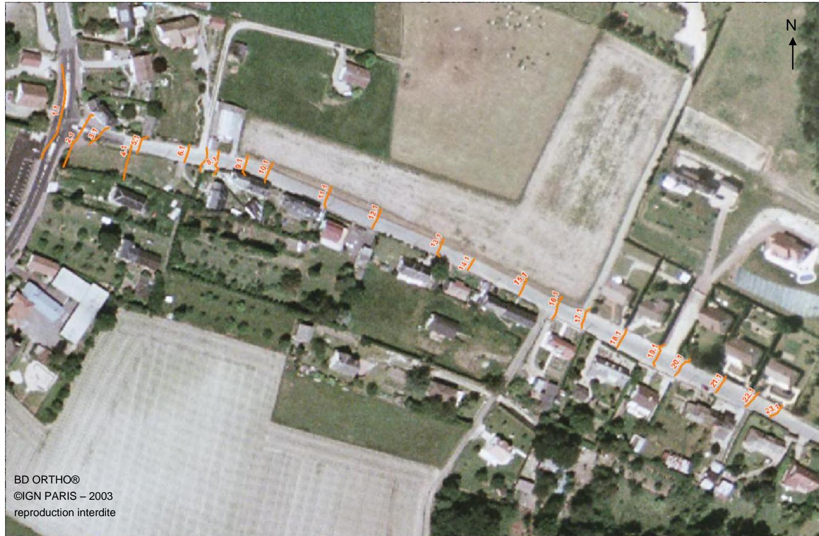
Figure 22 : Implantation des profils en travers du modèle hydraulique Val Phénix (document sans échelle)
