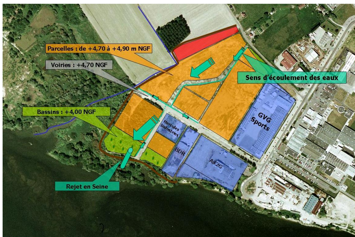
Figure 7 : Représentation schématique de l'écoulement des eaux
