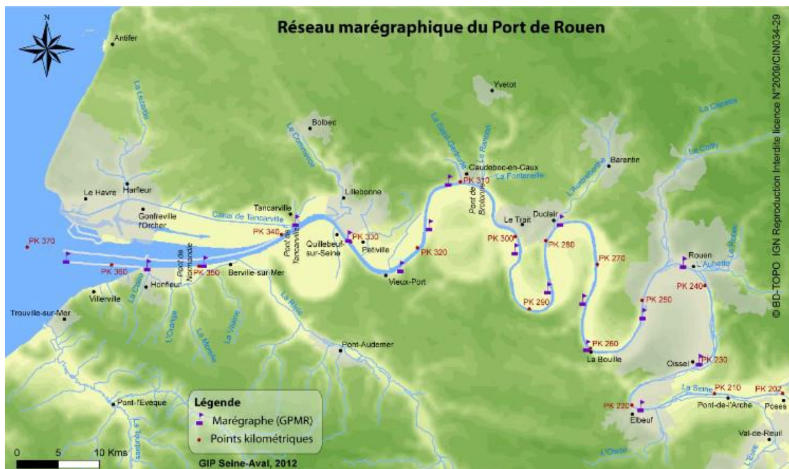
Illustration 1 : les 17 marégraphes de Seine du GPMR + Poses (capteur à l'aval du barrage, VNF et DREAL HN), fond GIP Seine-Aval
