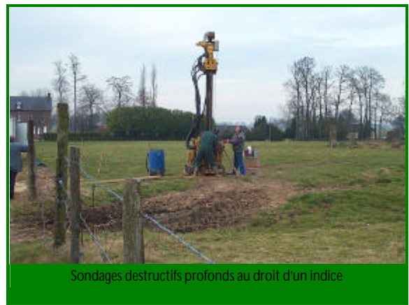
Photo 4(vues a et b) : Réalisation de sondages destructifs profonds
