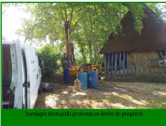
Photo 4(vues a et b) : Réalisation de sondages destructifs profonds
