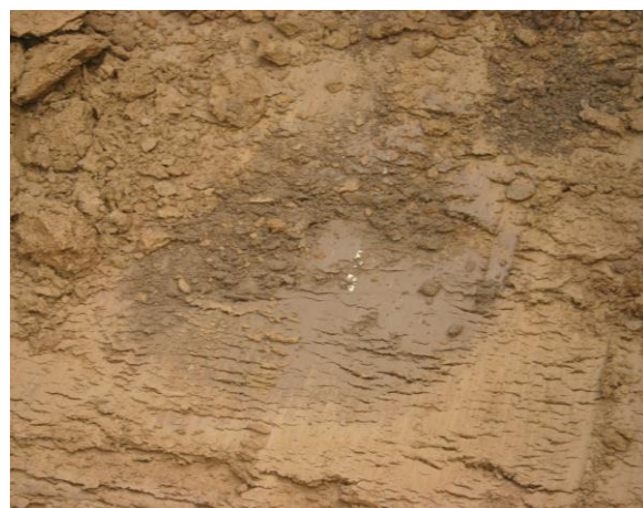
Photographies n° 9: Découverte d'un puits de marnière lors d'un décapage
