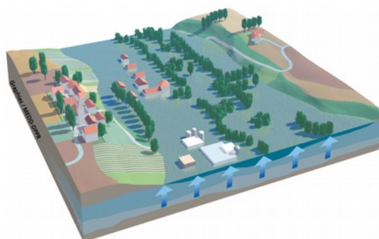
Figure 4: Inondation par remontée de nappe.
