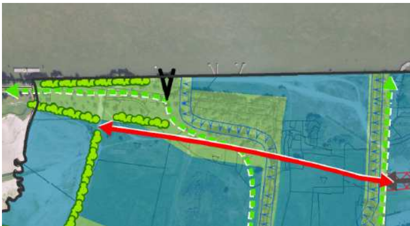
Préservation de la zone à risque d'inondation par un espace vert et des noues sur l'espace portuaire de Moulinaux
