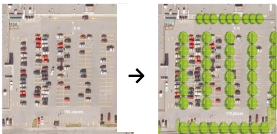
Végétalisation partielle du parking d'un centre commercial. Extrait d'un guide de bonnes pratiques, province de Québec.
