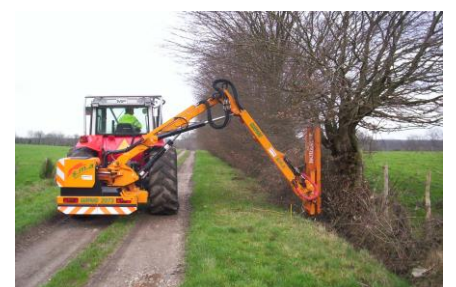
Taille d'une haie au lamier à disques
