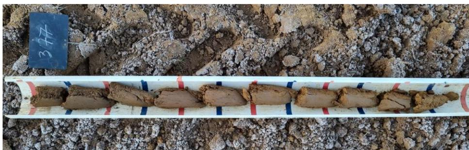
Fig. 48 : Exemple de profil de sol aux points de sondage
