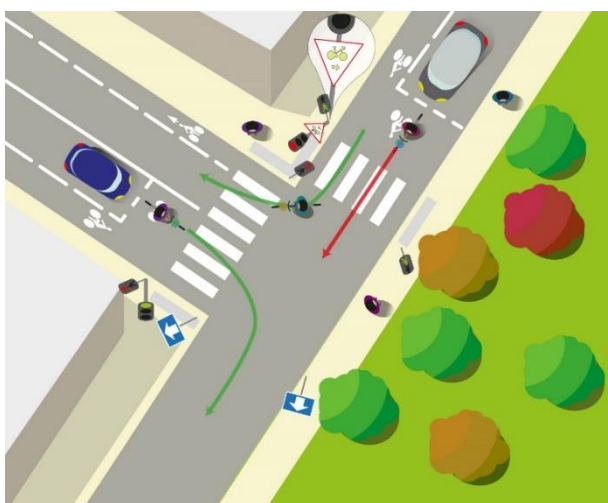
Schématisme de l'usage du cédez le passage cycliste et représentation des panonceaux de type M12
