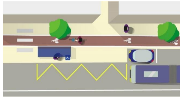
Piste cyclable à l'arrière du bus sans déviation du fait des stationnements
