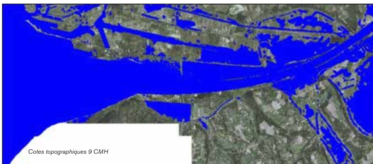
FIGURE 9.b : Projection (cote 9 CMH) avec une élévation du niveau marin (60cm + 40cm de surcote) Sources : IGN, PAR, PAH, MDE
