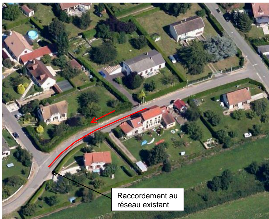
Figure 7 : Représentation graphique de la solution d'assainissement collectif étudiée pour le secteur rue des Foumares
