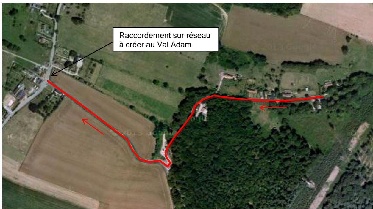
Figure 5 : Représentation graphique de la solution d'assainissement collectif étudiée pour le secteur Le Valnaye
