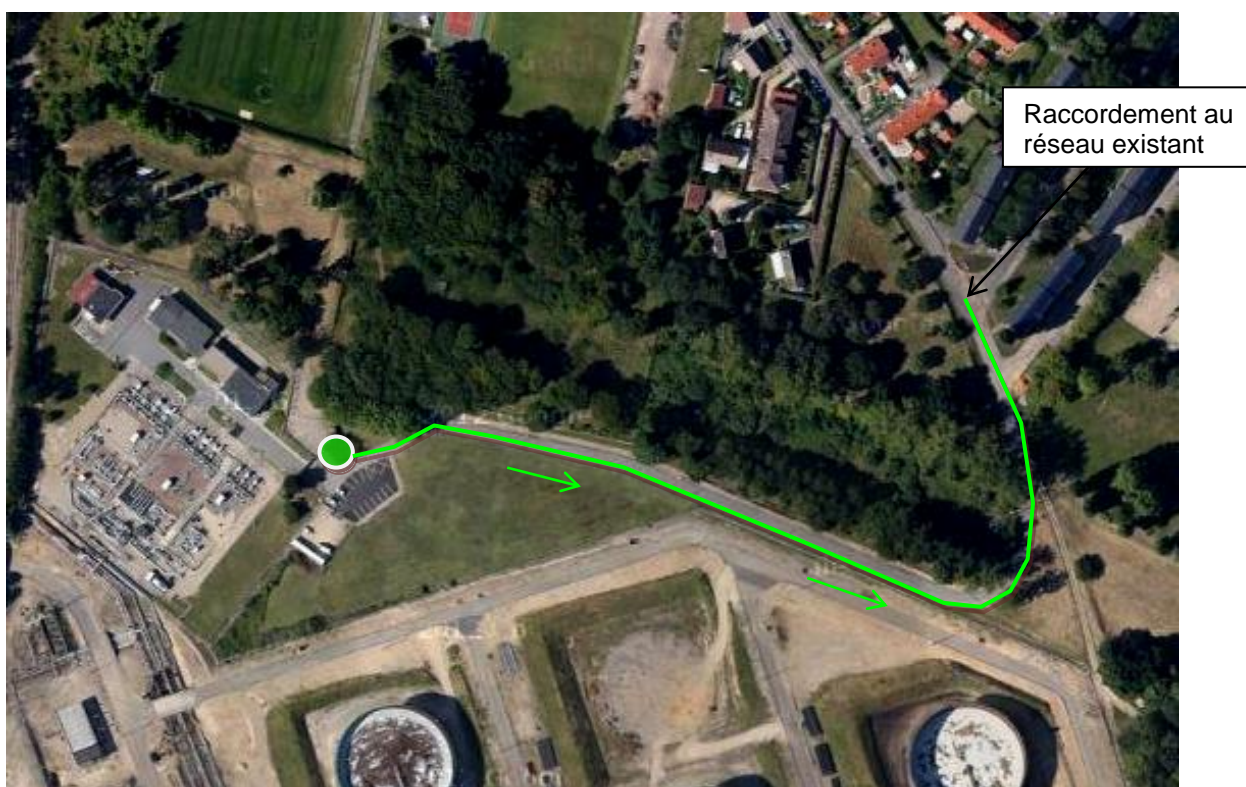
Figure 5 : Représentation graphique de la solution d'assainissement collectif étudiée pour la société Trapil
