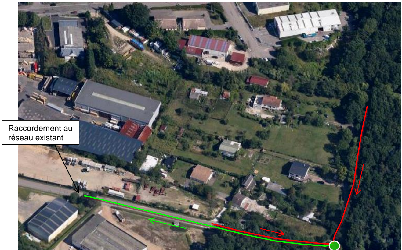
Figure 3 : Représentation de la solution d'assainissement collectif étudiée pour le secteur rue du 11 novembre prolongée
