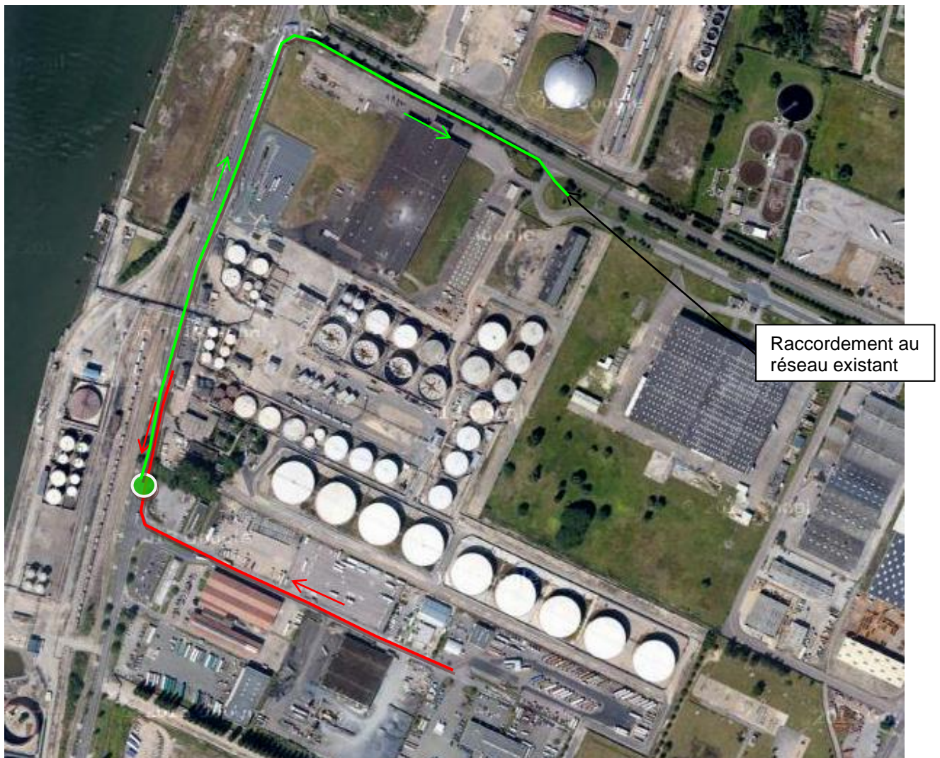
Figure 3 : Représentation graphique de la solution d'assainissement collectif étudiée pour le secteur boulevard de Stalingrad
