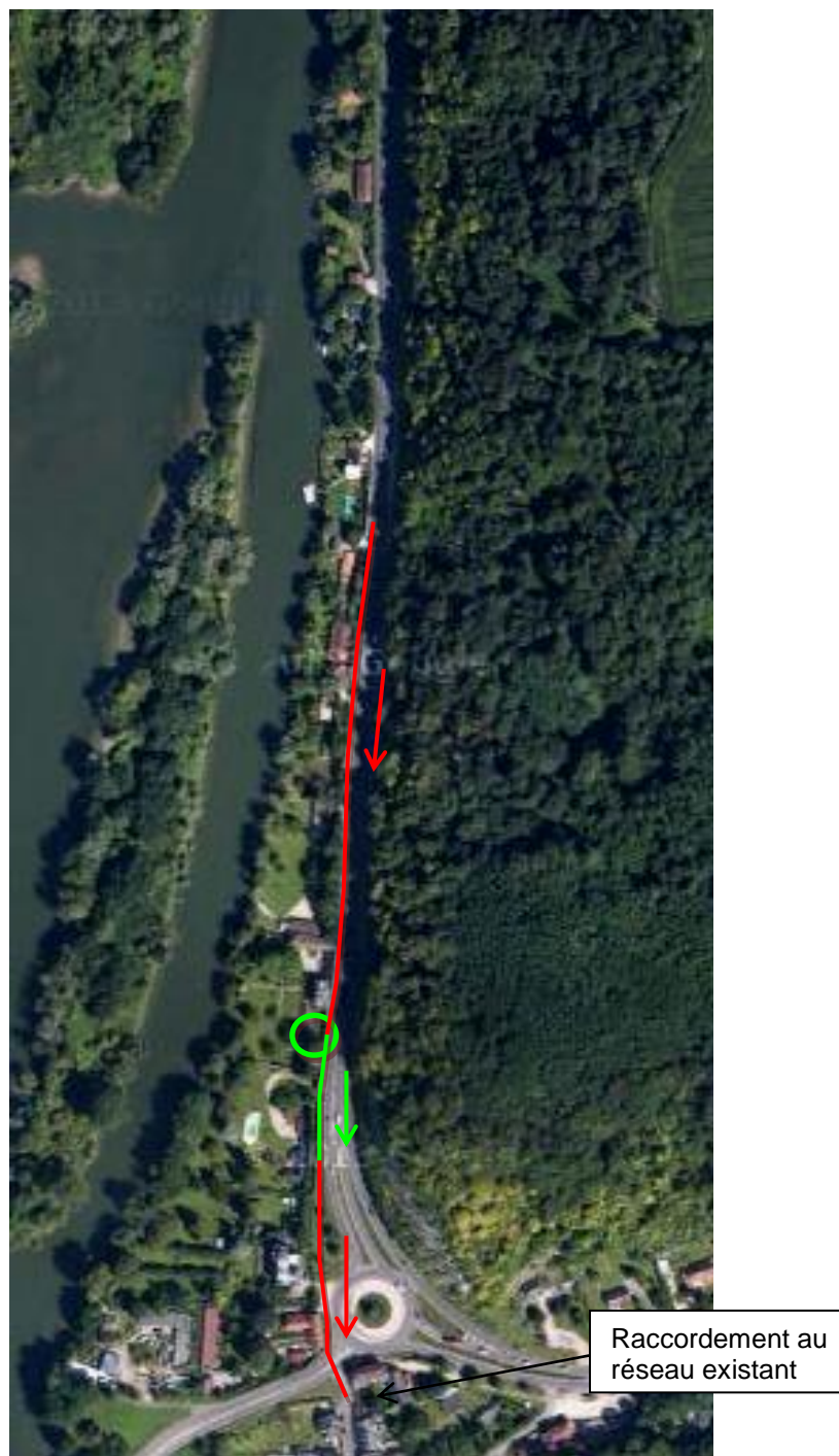
Figure 6 : Représentation graphique de la solution d'assainissement collectif étudiée pour le secteur RN15
