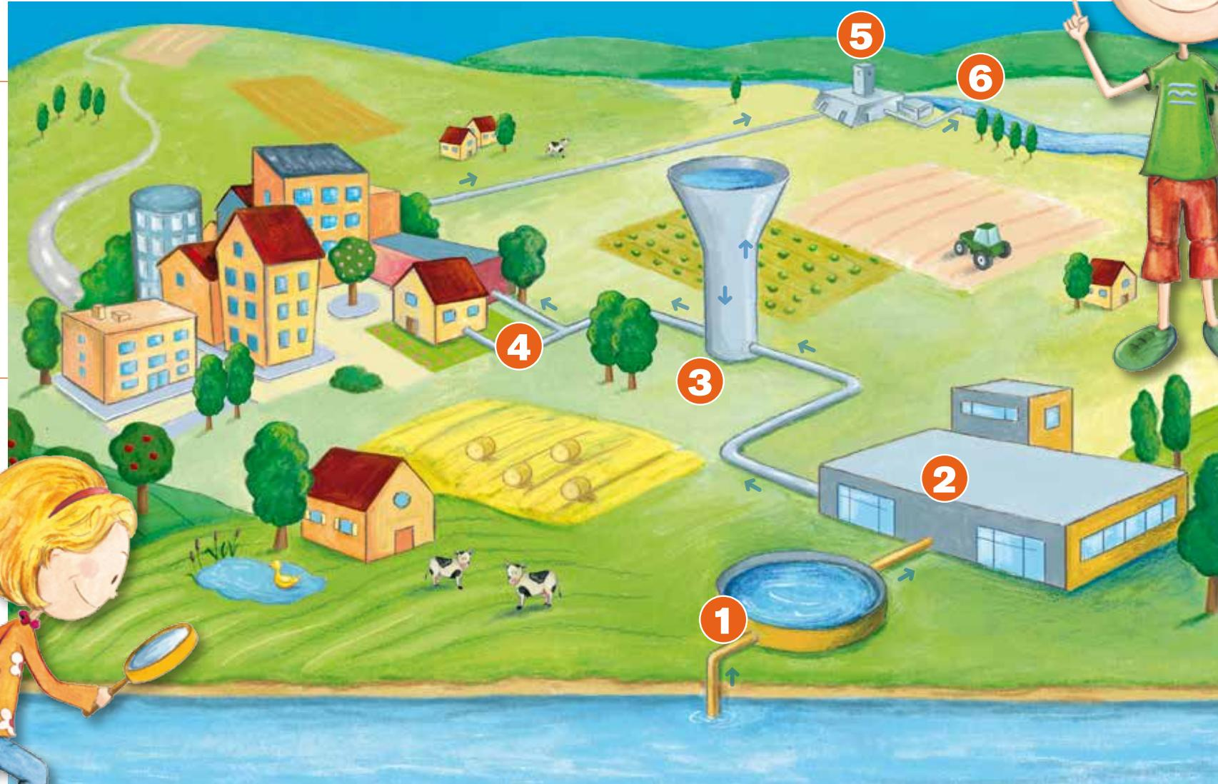
**Sur la piste du cycle de l'eau !** ① L'eau est pompée dans les nappes phréatiques. ② Elle est ensuite traitée dans une usine pour devenir potable. ③ L'eau est stockée dans les réservoirs et les châteaux d'eau. ④ Elle arrive jusqu'à ta maison par des canalisations souterraines. ⑤ L'eau est nettoyée dans une station d'épuration. ⑥ Elle est évacuée vers la Seine.
