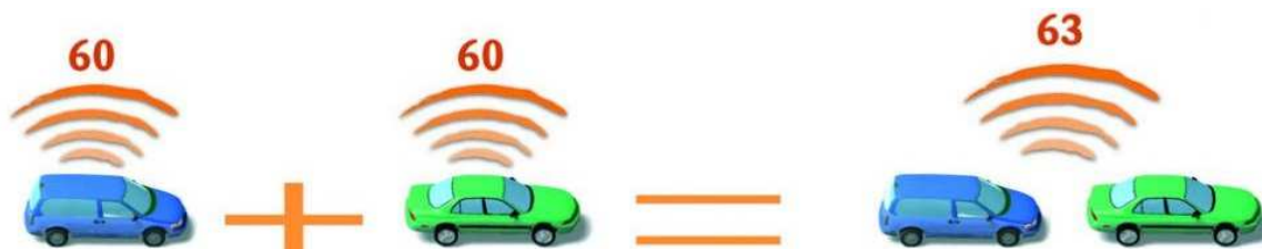
Figure 2 - Addition de deux sources de bruit de même intensité
