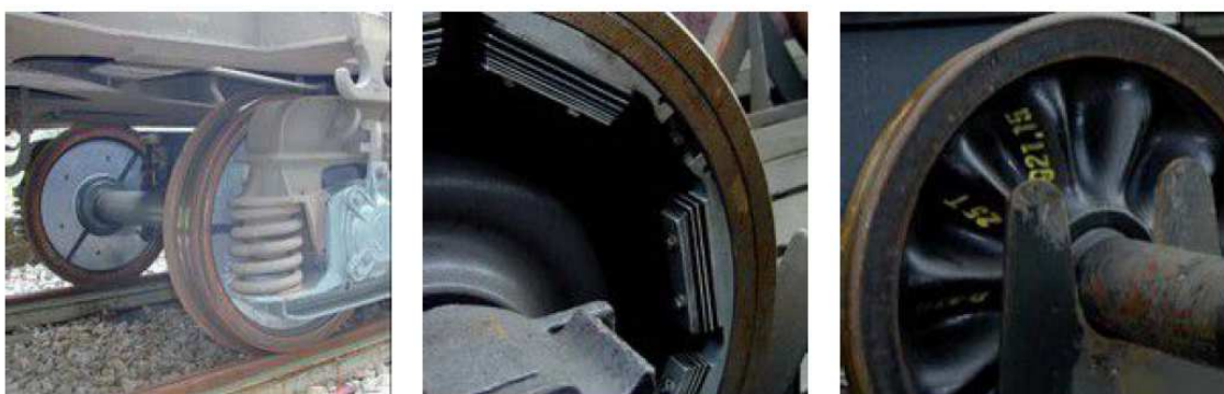
illustration 28 : exemples de roues optimisées
